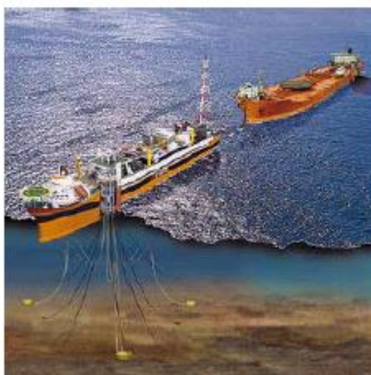
Figura 3.6.1-a. Operação de transferência de óleo entre o FPSO e o navio-tanque.
